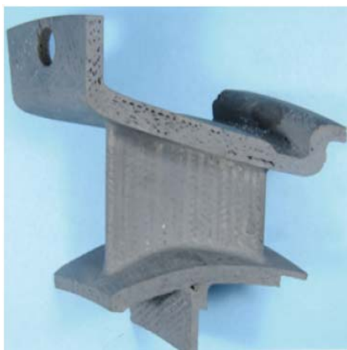
图 4 日本 IHI 公司制备的 \text{SiC}_f/\text{SiC} 复合材料静子叶片 [23] Figure 4 Appearance of \text{SiC}_f/\text{SiC} vane manufactured by IHI Co., Japan [23]
